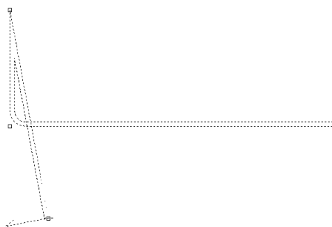
A „túlhúzott” fogópont miatt a vas már nem lekerekíthető
